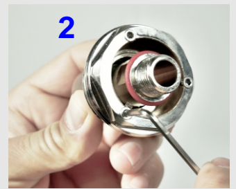
Rosette abschrauben mit 2,5 mm Inbusschlüssel Minischrauben lösen
