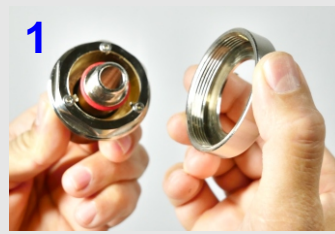
Rosette abschrauben mit 2,5 mm Inbusschlüssel Minischrauben lösen
