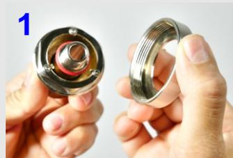
Rosette abschrauben mit 2,5 mm Inbusschlüssel Minischrauben lösen
