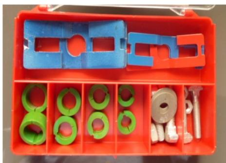
**1 Stück Reparaturkasten** für Stopfbuchs-Spanner-Erneuerung.
